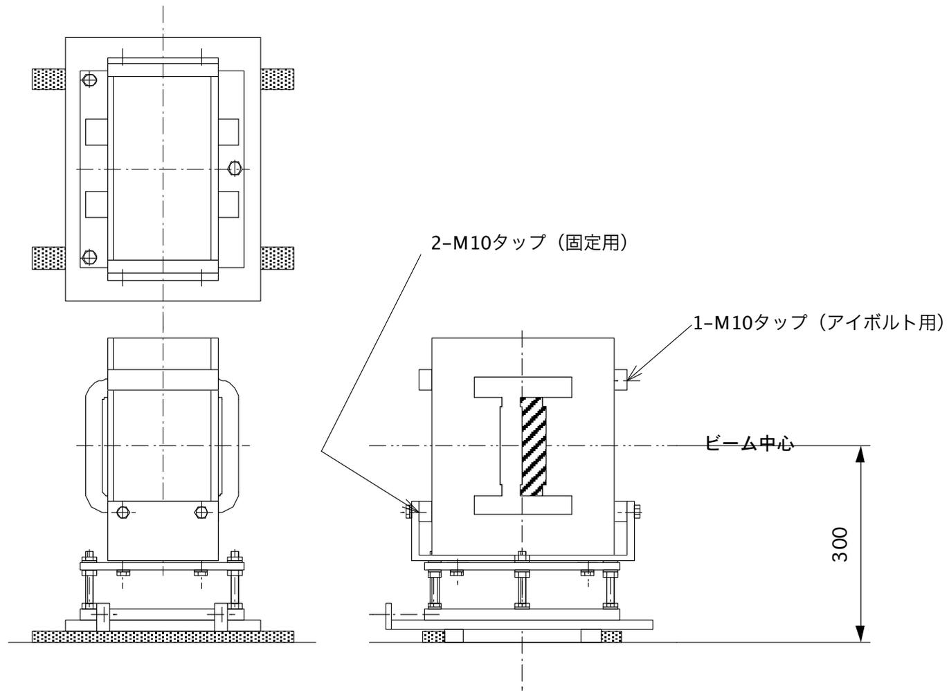
Fast Bump Magnet (垂直置き) 架台及び組み立て
