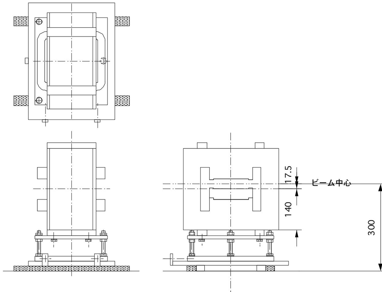
Fast Bump Magnet (水平置き) 架台及び組み立て
