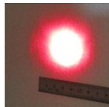
図6 : 500m 先でのレーザースポット ( $4\sigma=30\text{mm}$ )
