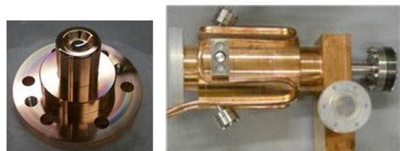
図3：Ir<sub>5</sub>CeカソードとDAW型RFガン空洞
