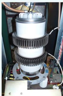
2019年3月現在運転しているサイラトロンの平均運転時間は約 34,000時間である。また、故障により交換したものの平均運転時間は約 38,000時間である。
