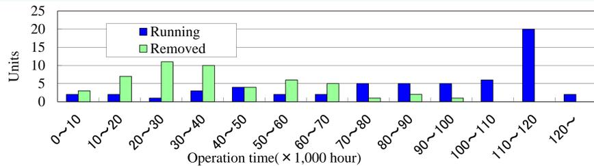
現在使用中の導波管高周波窓は11~12万時間使用しているものが最も多く、平均運転時間は約84,000時間である。撤去済み導波管高周波窓の平均運転時間は約59,000時間である。
