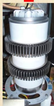
・KL\_17 ユニットから撤去したサイラトロン上部放熱フィン接続部での放電痕
