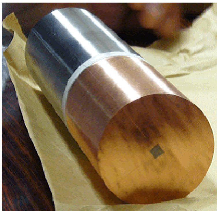
図 1.4: HIP 加工された 11mm 単結晶標的
