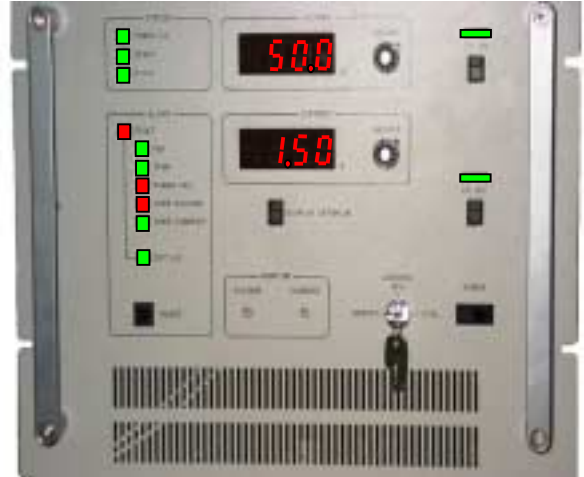
図 3. 50kV 30kJ/s インバータ電源試作機外観
