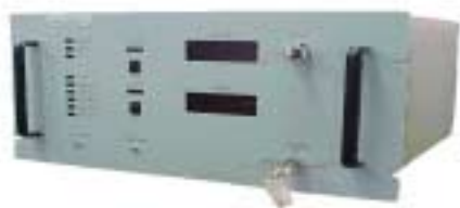
図 1. 10kV 6kJ/s インバータ電源外観
