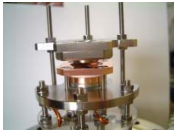
図2：測定に使用した三極管型の試験用電子銃
