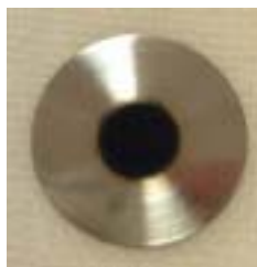
図3：陰極の1例。中央の直径6mm部分が陰極。
