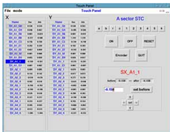
図5：仮想タッチパネル電磁石調整パネル
