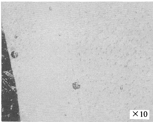
写真1 赤道溶接部に発生したスパッタボール
