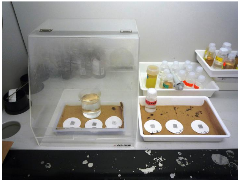
図13: 水分(湿度)を十分に与えた状態(左)と室内(右)でのシミ発生試験。
