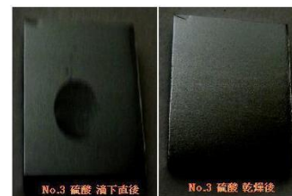
図6: 98%硫酸を滴下した試験。シミは発生せず。
