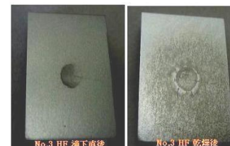
図7: 46%フッ化水素酸を滴下した試験。シミが発生。
