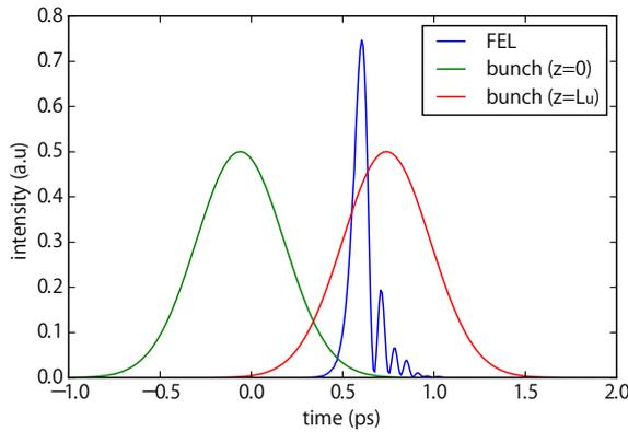
Figure 3:  $L_s/L_b = 1.67$ ,  $j_0 = 10$ ,  $\alpha = 2\%$  とした時の飽和後の FEL 波形. アンジュレータ入口, 出口での電子バンチの波形も合わせて示す.
