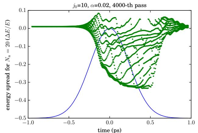
Figure 5:  $L_s/L_b = 1.67$ ,  $j_0 = 10$ ,  $\alpha = 2\%$  とした飽和後の電子バンチのエネルギー分布. エネルギー広がりは約 40% (全幅) である.
