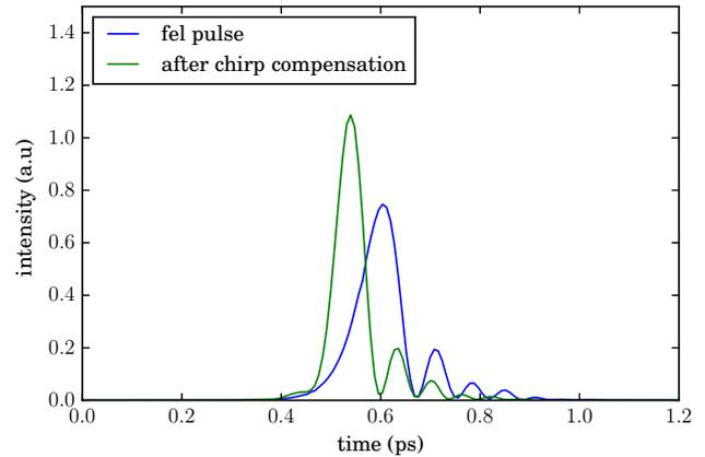
Figure 4:  $L_s/L_b = 1.67$ ,  $j_0 = 10$ ,  $\alpha = 2\%$  とした時の飽和後の FEL 波形にチャープ補償を施した場合. チャープ補償後の FEL パルス長は 1.6 サイクル (FWHM) まで短くなる.
