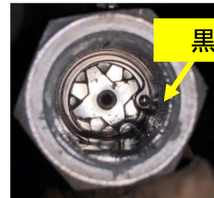
流量制限器内部
