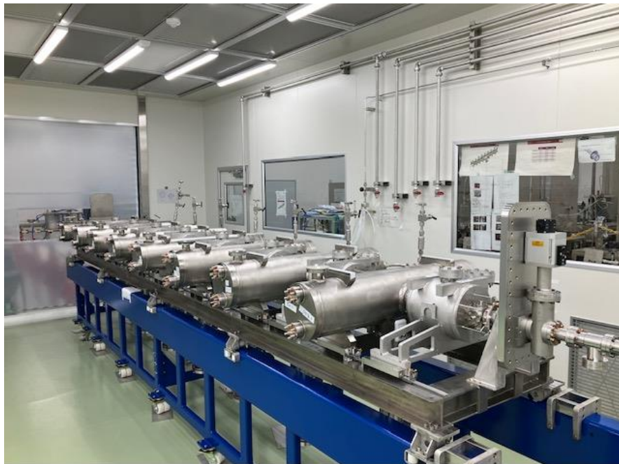
六ヶ所研のクリーンルーム内 接続された超伝導空洞とソレノイド8式
