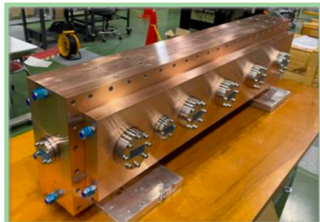
ミュオン用IH-DTLでの加速
