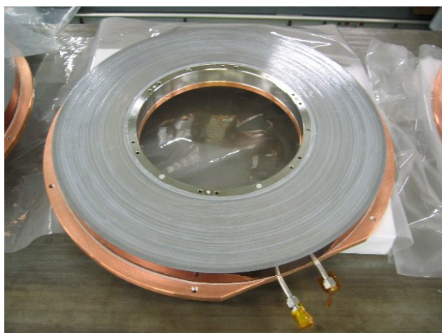
図4 冷却銅板を接着したコア
