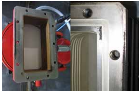
写真3:フラットフランジとOリングフランジ放電痕面の研磨とOリング交換を行った。
