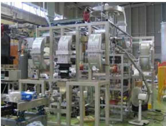
写真2:STF導波管-電力切り替え部
