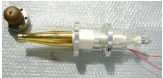
図6. 電子銃パルス伝送路.
