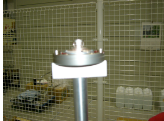
図5. カソード交換治具の写真
