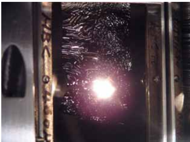
第6図 照射中の炭素薄膜上のビームスポット
