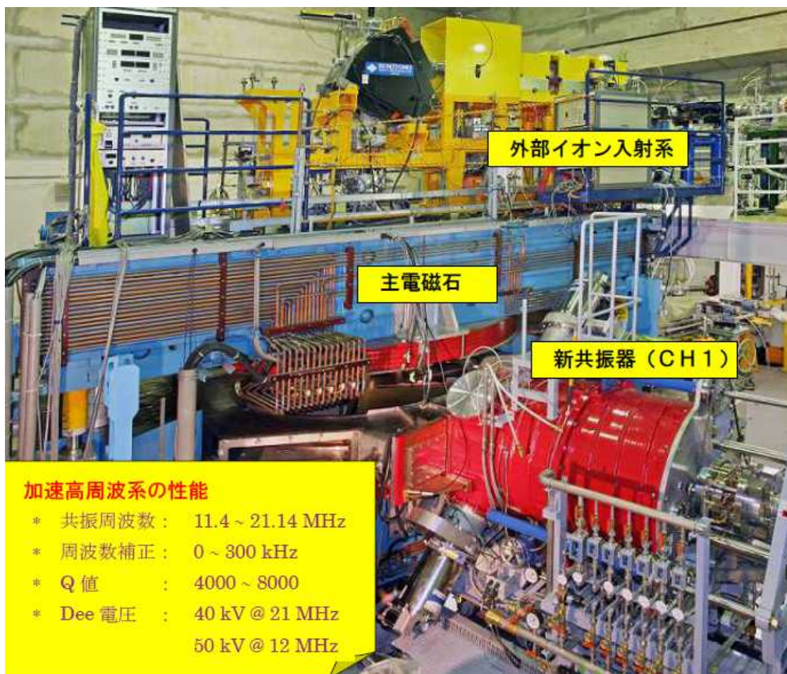
図1 . NIRS-930サイクロトロンと更新された高周波共振器
