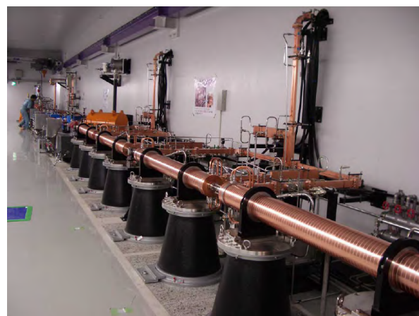
図1, 加速器下流から撮影したCバンド加速器。熱膨張係数の小さいコージライト架台が採用されている。
