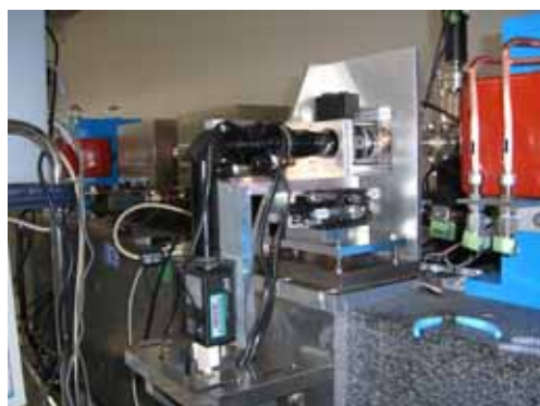
図3 . CCDカメラ及びレンズ配置
