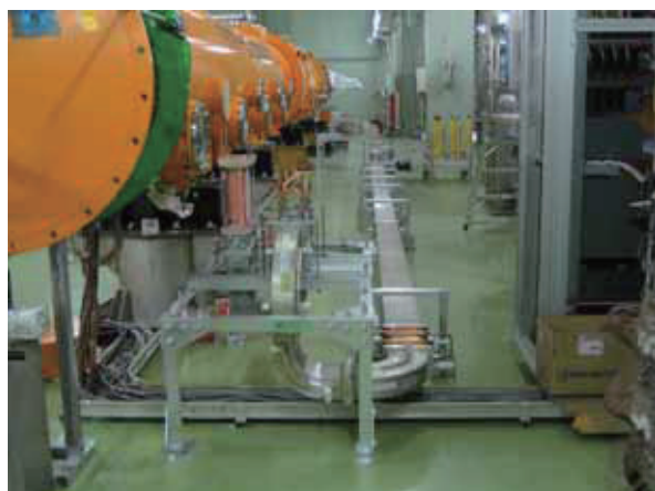
図1:STF Phase1空洞とWR-650導波管系
