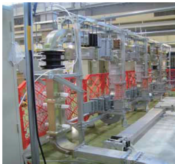
図2:STF Phase1の導波管系
