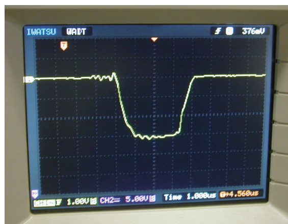
図3. 新クライストロンのマイクロ波出力を加速管に入れた時の加速管ダミーロードモニタ検波器波形（加速管1本あたり約5MWのマイクロ波を入力）
