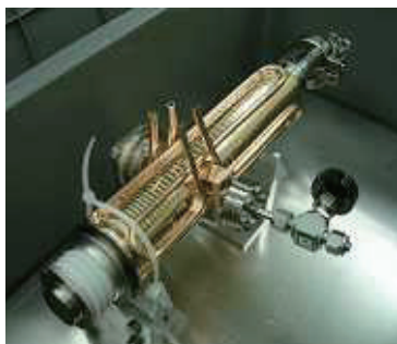
図5 電子銃とRF窓を溶接した加速管写真
