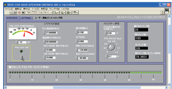
図4 バンチパターン制御画面。
