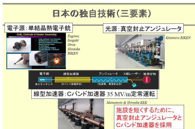
図2 XFEL/SPring-8を構成する三要素。
