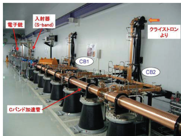
図 3 : SCSS試験加速器トンネル内、Cバンド加速管の全景。
