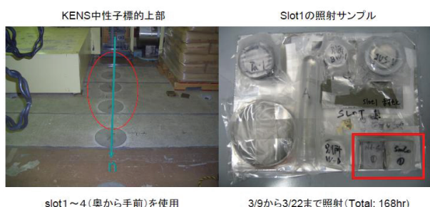
図1 KENSでの実験セットアップ。KENS中性子標的下流の縦穴上部(右図)およびSlot 1に設置した磁性体試料
