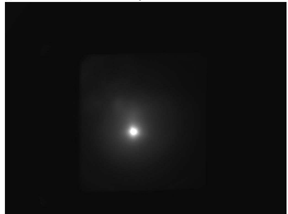
図6 : 電子ビームスポット (CCDカメラによる)
