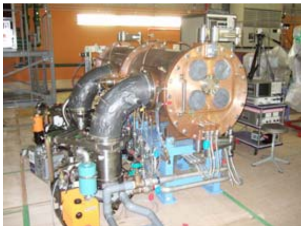
図2 : RIBF実験棟に搬入された4-Rod RFQ [18]
