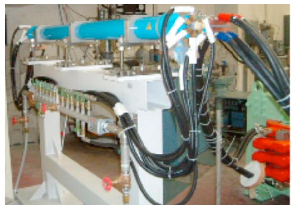
図4: 青い筒の部分がパルス6極電磁石の本体である。
