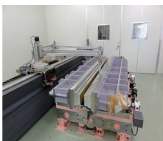
図 6 : THz 光発生用 Halbach Planner type アンジュレータの磁場測定状況
