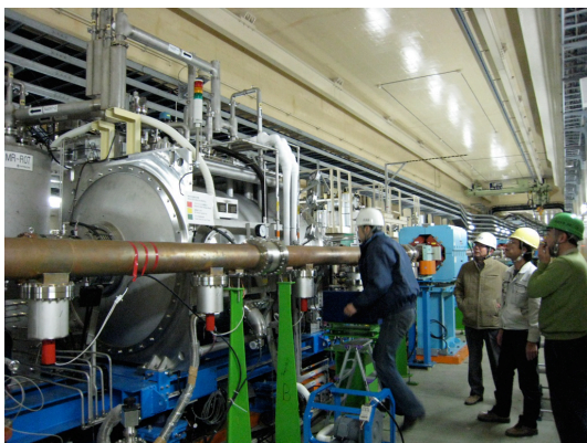
図 1: リング外側の LER に設置されたクラブ空洞。手前側には HER のビームパイプがある。
