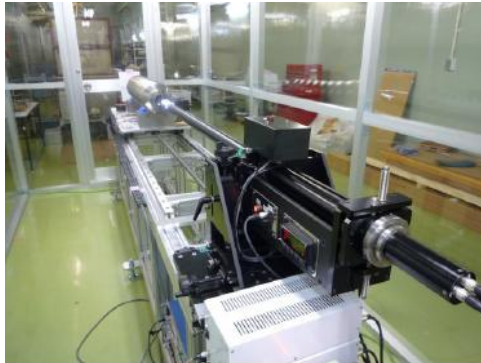
図4. 空洞内面検査用に新たに開発されたカメラ
