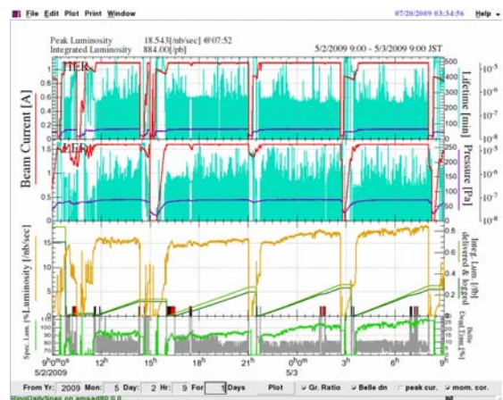
図 7 : スキュー六極電磁石を導入した時のルミノシティの様子(1 日分)
