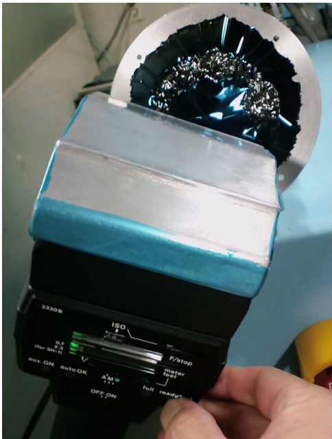
図 7 : 回転シリンダーストリッパー用のホルダー (穴径 80mm) に貼り付けた PCC-foil に写真用ストロボで閃光を照射
