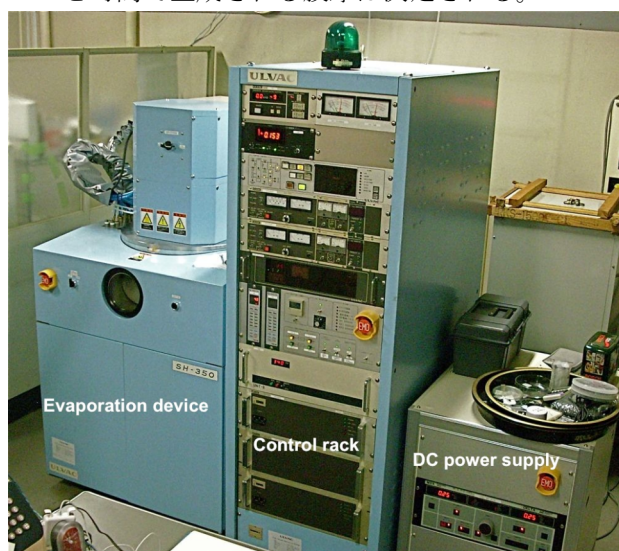
図 1 : 高真空スパッタ源蒸着装置 SH-350 by ULVAC
