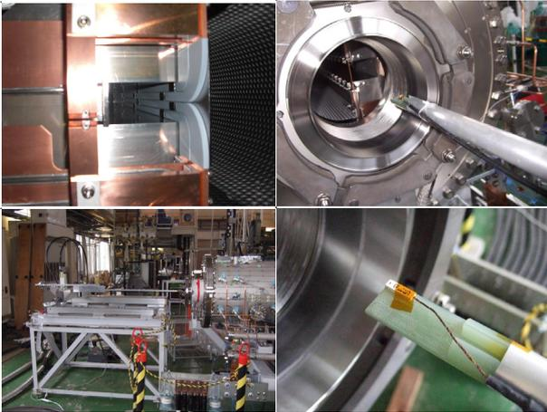
図4：低・中磁場セプタム磁場測定状況
