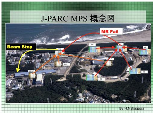
図 2: 現行の J-PARC 加速器 MPS の概略を示す。分散配置された MPS 信号集約装置が受信した MPS 信号は光ファイバケーブルを通じて、最終的には中央制御室に設置された中央集約装置に集約される。中央集約装置は LINAC に設置されたビーム遮断のための装置を通じて、ビーム供給を停止する。
