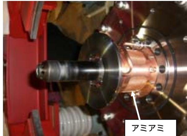
図 3 . 部品交換後の引出電極。台座を交換した。
