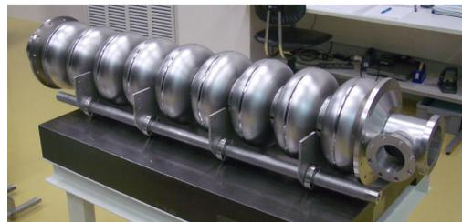
図 9：1.3GHz 9 セル空洞試作 1 号機
