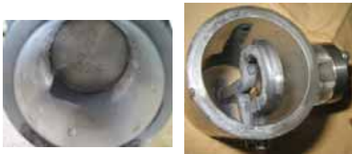
図 4：純水高圧洗浄後の Input coupler port 内面（左）と HOM coupler 内面（右）の状態
