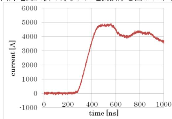
図5：キッカー電磁石の出力電流波形
