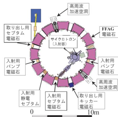
図 1 : 150MeV FFAG 加速器の概略図
