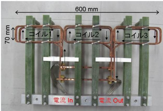
図2：開発したキッカー電磁石の概観
