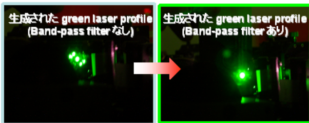
図 4. 系の改良前後の green laser beam profile
