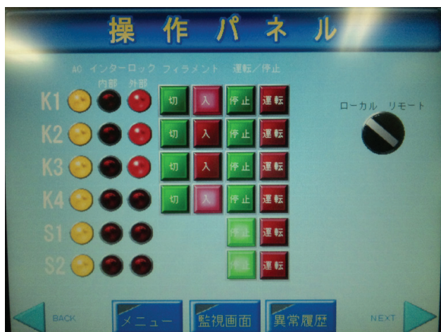
図3：現場制御の動作試験時に使用したタッチパネル画面の一例。左からステータス表示、スタンバイ入切操作とその状態、運転停止操作とその状態。
