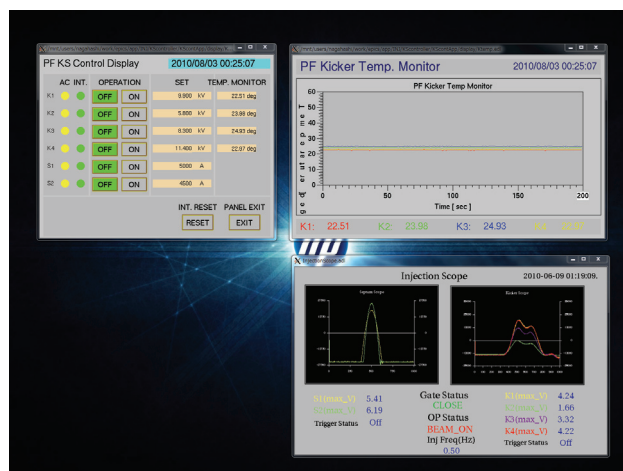
図4：遠隔制御の動作試験時に使用したGUI。左上がステータス表示と運転停止操作、右上がキッカー電磁石表面温度の監視、右下がキッカー電磁石とセプトム電磁石の電流波形とそのピーク値。
