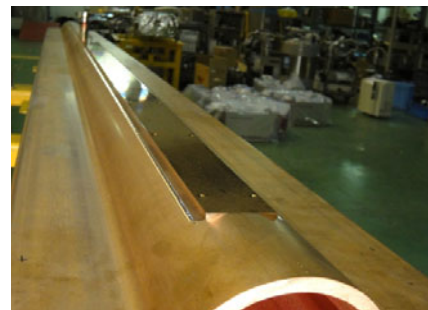
図 6 : 実機ビームパイプに電子ビーム溶接で装着された長さ 1.7m のクリアリング電極。端に同軸導入端子が接続される。
