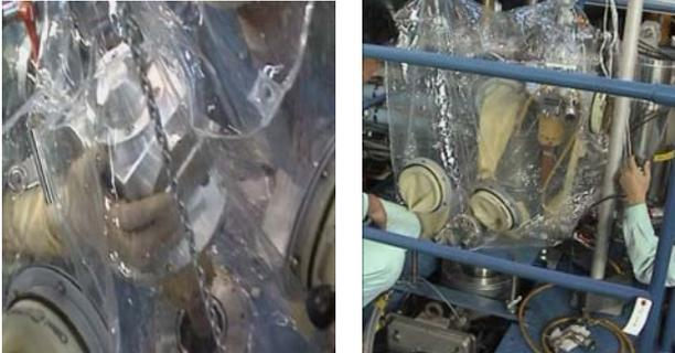
図3、コールドメンテ作業写真、ピストンの吊上げ移動。
