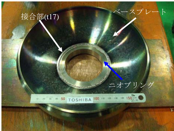
図 7:ベースプレートの厚板溶接
