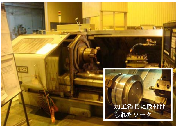
図 4 : NC 旋盤による半セルの接合部開先加工
