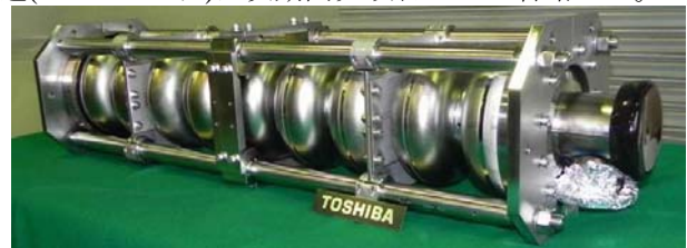
図 1 : 東芝製 1.3GHz 9 セル超伝導高周波加速空洞 HOM カプラなし試作機。2010 年 4 月完成。
