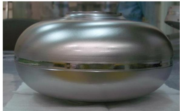
図 3 : 赤道溶接の試作材
