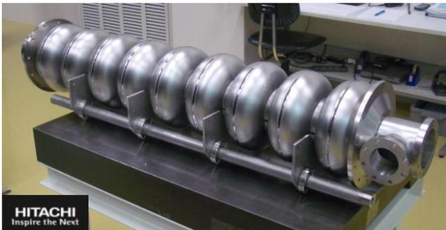
図 5：9 セル超伝導加速空洞試作 1 号機
