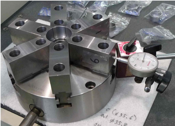
図 10 : 応力緩和材料の追従性確認用六爪チャック試験機
