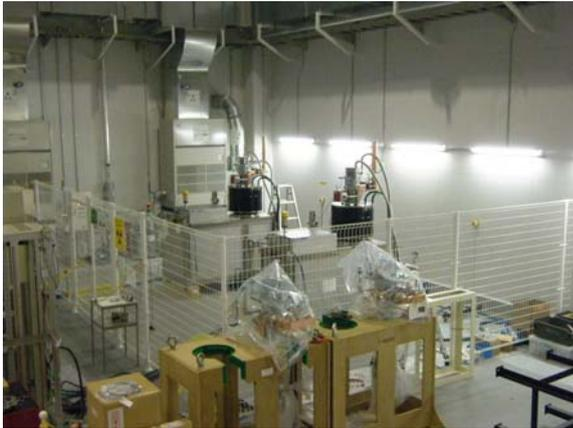
図 3: モジュール電源の試験エリア。フェンス内は管理区域に設定され、2 台同時に運転が可能である。
