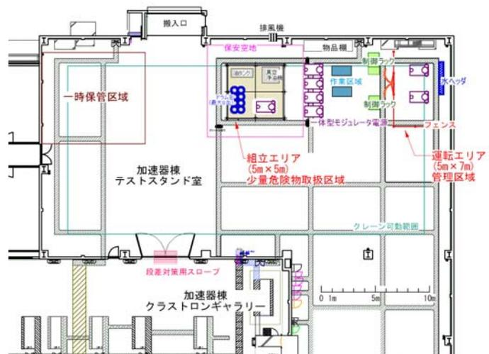
図 1:左) 一体型モジュレータ電源。右) テストスタンド室内における、保管エリア、組立エリア、運転エリアの配置図。
